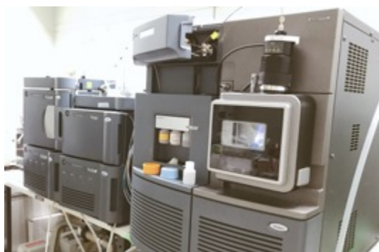
図 3. 高速液体クロマトグラフタンデム型質量分析計(LC-MSMS)
