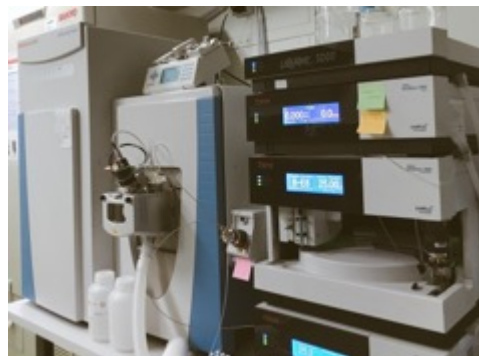
図 4. 高速液体クロマトグラフ高分解能質量分析計(LC-HRMS)
